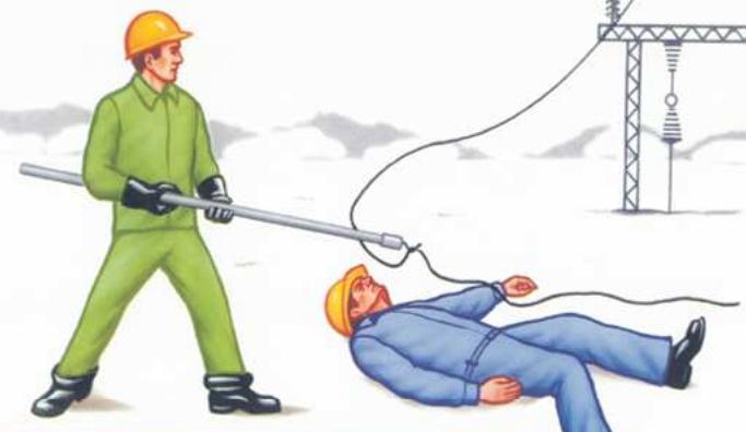
Спасатель должен надеть диэлектрические боты, работать в диэлектрических перчатках. Действовать необходимо изолирующими штангой или изолирующими клеммами, рассчитанными на соответствующее напряжение. Остальные меры предосторожности те же, что и при низковольтной травме.
